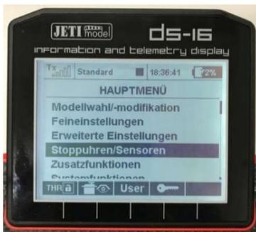
2. Im Untermenü „Stoppuhren/Sensoren“ nun den Menüpunkt „Telemetrieanzeige“ auswählen:
