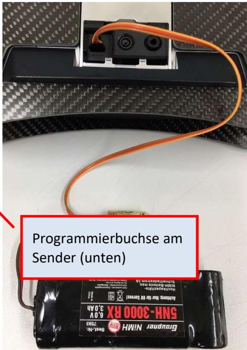
Nachdem die Verbindungen gemäß Variante A oder B (s.o.) vorgenommen wurden kann mit dem Anmelden des Sensors (=Telemetrie Adapters) über den Sender fortgefahren werden. In beiden Fällen ist das Telemetrie Kabel welches normalerweise zum Empfänger geht in die Programmierbuchse am Sender einzustecken. Das Foto links zeigt die notwendigen Verbindungen im Falle von Variante B (Versorgung über separaten Akku) an einem T18MZ Sender.
